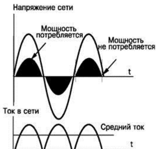
Рисунок 7. Ток и мощность, потребляемые источником питания без коррекции (а) и с коррекцией (б).
